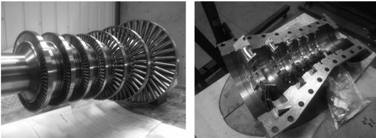
Рис. 4. Проточная часть осевой микротурбины
