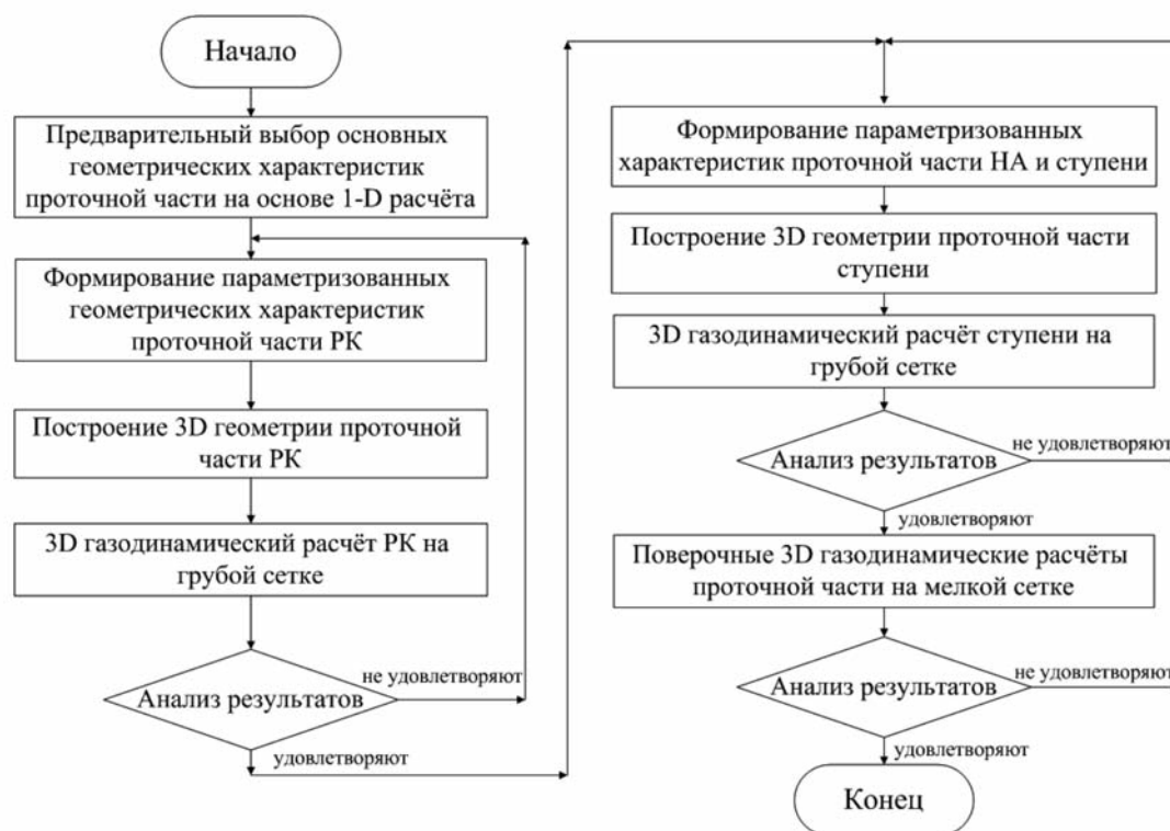
Рис. 1. Блок-схема алгоритма проектирования проточной части ступени
