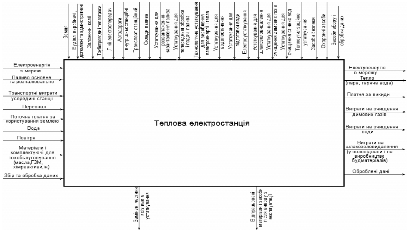
Рис. 8. Техніко-економічний аспект функціонування теплової електростанції
