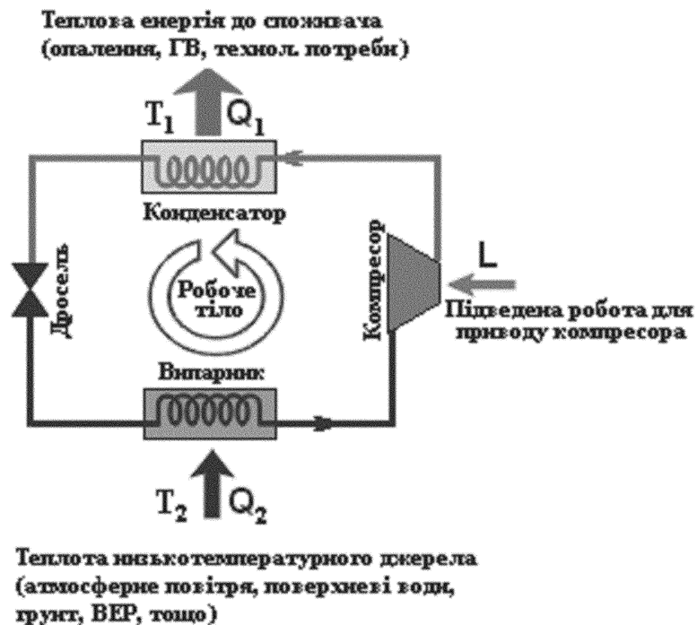
Принципова схема компресійної теплонасосної установки
