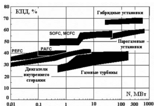
Рис. 3. КПД и мощность перспективных энергетических установок на природном газе [1]: PEFC – топливный элемент с протон обменной мембраной; PAFC – фосфорнокислотный топливный элемент; SOFC – топливный элемент с твердооксидной мембраной; MCFC – топливный элемент на расплавах карбонатов
